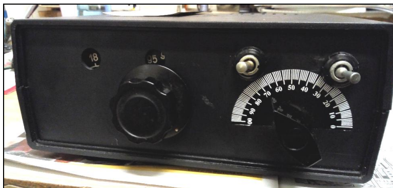
Vlevo je variometr Třinec, vpravo je vzduchový otočný kondenzátor 3 \times 500 \text{ pF} ze starého elektronového rádia, vyhovuje pro výkon od QRP až po 400 W
